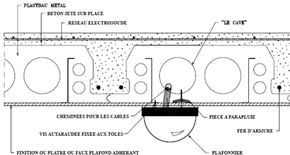
Prédisposition pour l'accrochage des corps légers lorsque la dalle a été réalisée, avec faux plafond qui n'est pas collé. Elément à parapluie fixé à la solive en Placoplâtre avec installations électriques dans les creux de la
