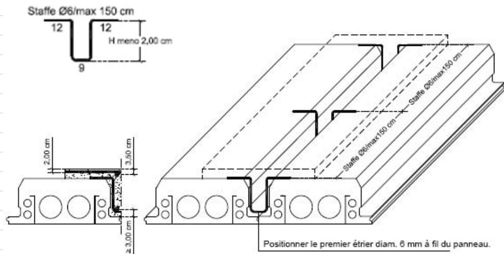
L'armure supérieure des solives est positionnée au niveau des supports et liés au-dessous du réseau soudé électriquement.
