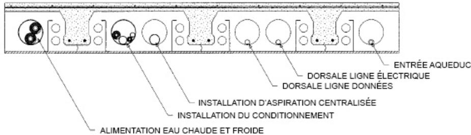
Il est possible d'optimiser les épaisseurs en positionnant les installations à l'intérieur des cheminées longitudinales dans les panneaux, avec une réduction de l'épaisseur au niveau de l'intrados de la dalle. En juxtaposant les panneaux à emboîtement (mâle-femelle) il est possible de réaliser une solive qui abrite le fer d'armure (droit, tronçon et mouluré) à intégrer dans le couplage **Plastbau® Metal** tout en éliminant les ponts thermiques.
